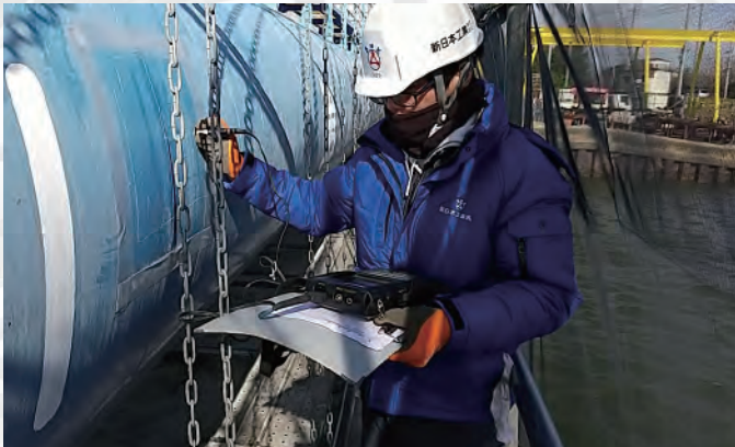
超音波管厚測定器による管厚測定
